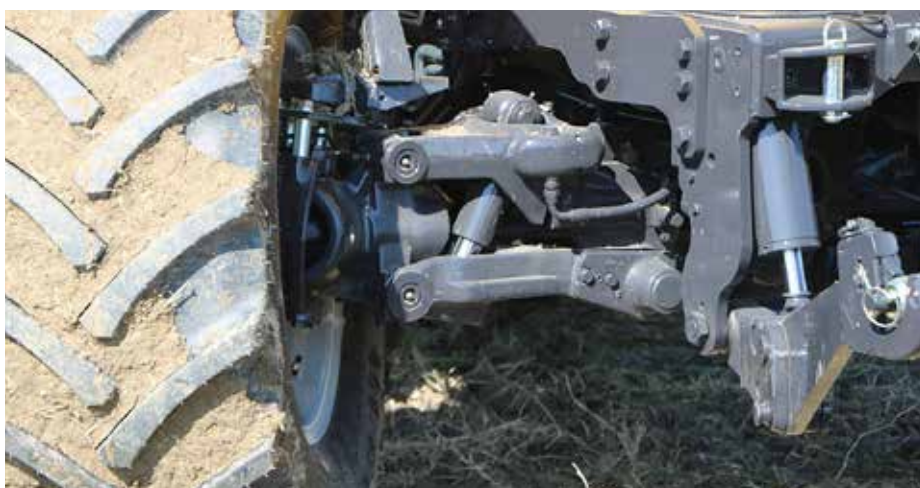
Opcijsko posamično vzmetenje sprednjih koles proizvajalca Carraro. Priporočljivo za izvedbo traktorjev s hitrostjo 40 km/h in nujno za izvedbo 50 km/h.
